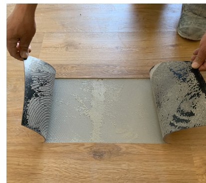
Eine Überprüfung der Klebung hat ergeben, dass die Klebstoffmenge als ausreichend eingestuft werden konnte und die Einlegezeit nicht überschritten wurde.
